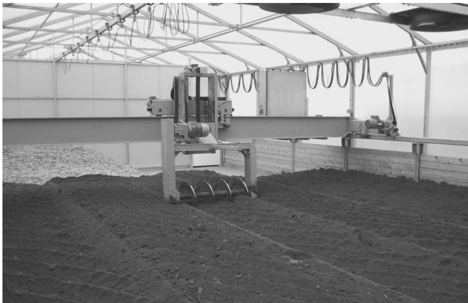
Figura 12.43. Modelo de volteo automático en funcionamiento.
