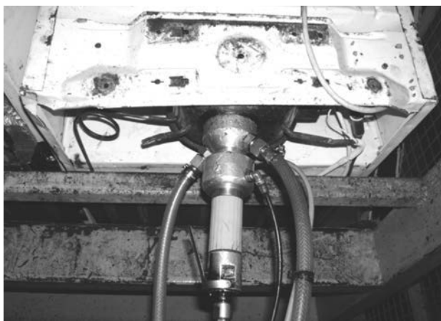
Figura 14.13. Cabezal de extracción succionando la mezcla CFC/aceite de un compresor frigorífico.
