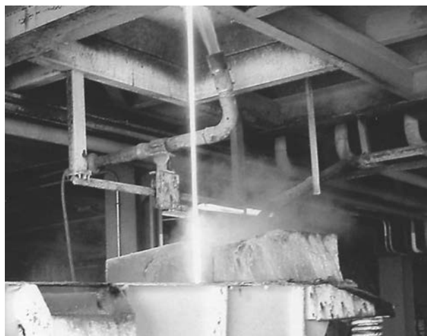
Figura 7.16. Salida del vitrificado en un horno de gas.
