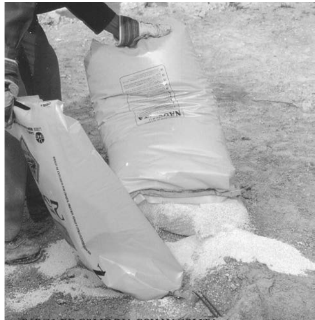
Figura 9.8. Envase contenedor de materias explosivas.
