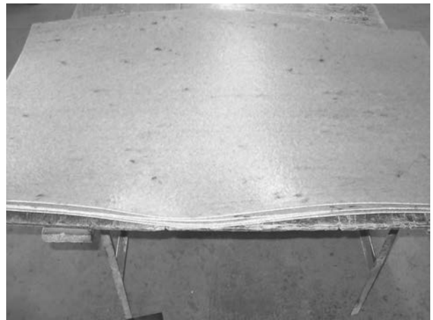
Figura 5.41. Corte y moldeo de láminas de composite de fique.
