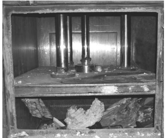
Figura 14.16. Foto de la prensa interior del triturador.
