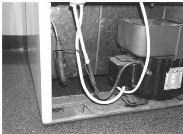
Figura 14.14. Foto partes desmanteladas manualmente: Filtro, cable y motor.
