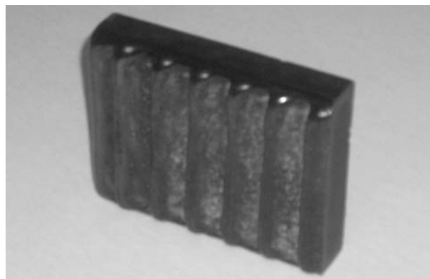
Figura 9.49. Baldosa para alto tráfico para plazas, paseos o estaciones fabricada a partir de escorias de fundición.
