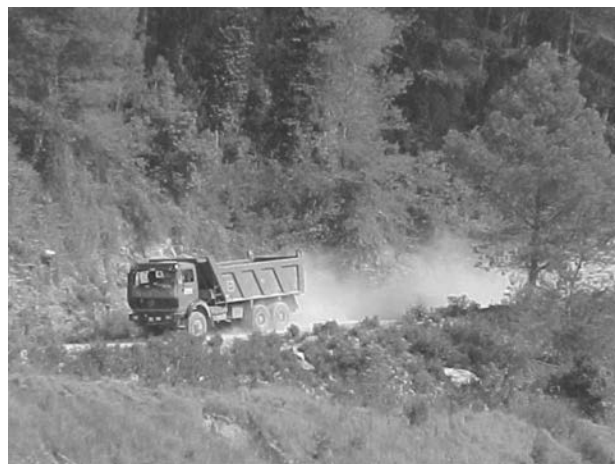
Figura 9.15. Producción de polvo durante el transporte de roca.
