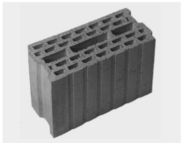
Figura 12.3. El Ecobrick, ladrillo fabricado con fangos de EDAR.
