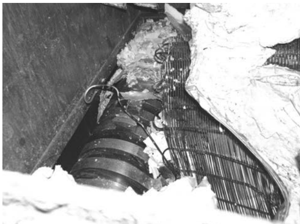
Figura 14.15. Foto de las cuchillas desgarrando un frigorífico.
