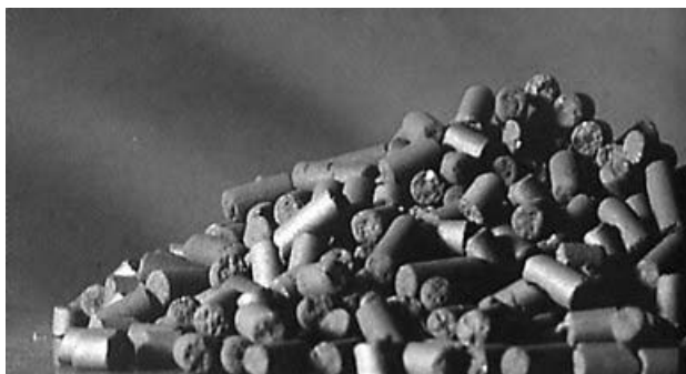
Figura 5.44. Forma comercial de carbón activado paletizado.
