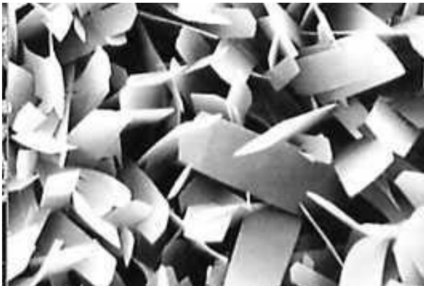
Figura 5.20. Microestructura de un material absorbente acústico.
