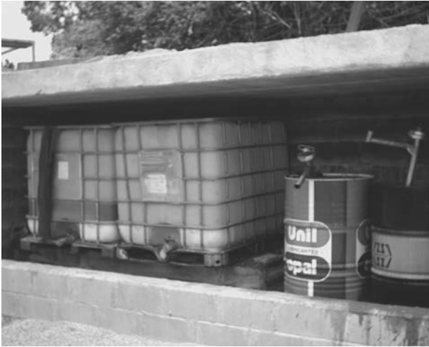
Figura 9.12. Almacenamiento temporal de aceite mineral usado.
