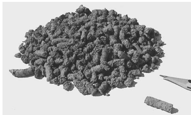
Figura 5.49. Soporte agrícola de cerámica fabricado con residuos.
