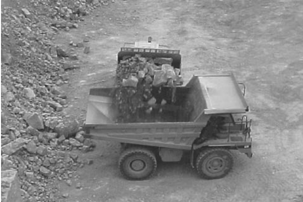
Figura 9.9. «Dumper» usado para el transporte en el interior de las zonas de extracción.
